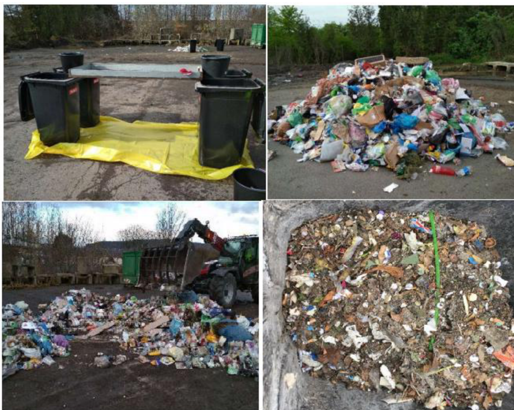
Obr. 6 Fotografie rozboru odpadu podle Odpadové poradenské - stanoviště vzorkařů (vlevo nahoře), hlavní vzorek odpadů (vpravo nahoře), kvartace pomocí nakladače (vlevo dole) a frakce pod 40 mm (vpravo dole) [22]
