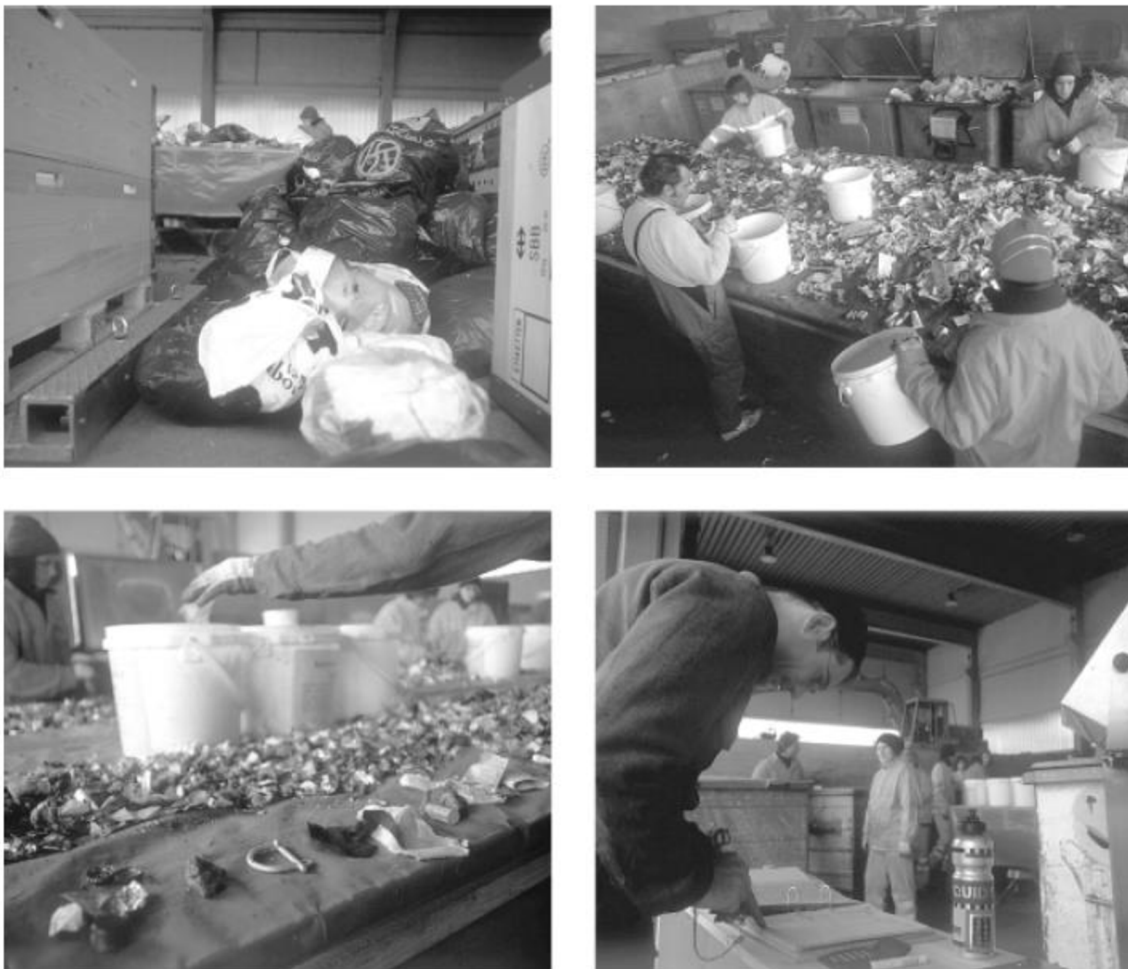
Obr. 11 Postup třídění - dodaný odpad (vlevo nahoře), třídění (vpravo nahoře), rozdělení na frakce (vlevo dole), vážení a záznam (vpravo dole) [28]
