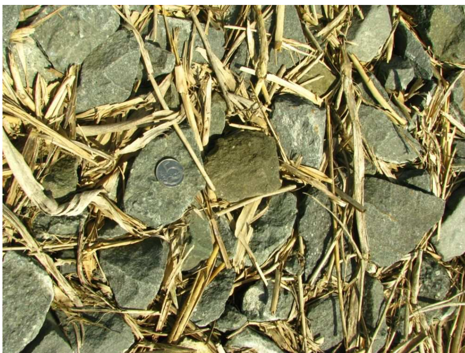
Obr. 7: Velikost kameniva rozvodné zóny na KČOV Čehovice
