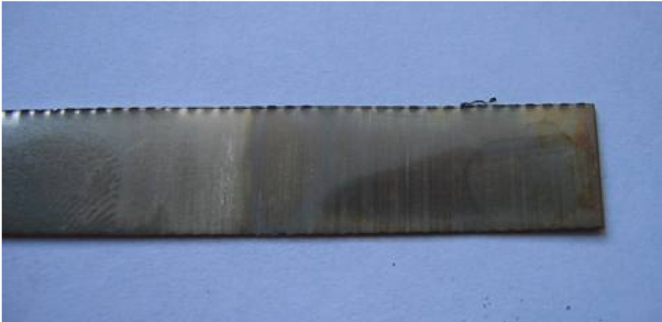
Obr 9: Nanesená vrstva oxidu niklu na Ni elektrodě
