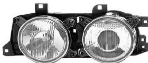
obrázek 6.2: Super DE systém, hlavní světlomet pro vozy s regulací sklonu světel [20]
