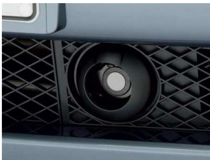
obrázek 9.2 Umístění termovizní kamery v předním nárazníku [4]
