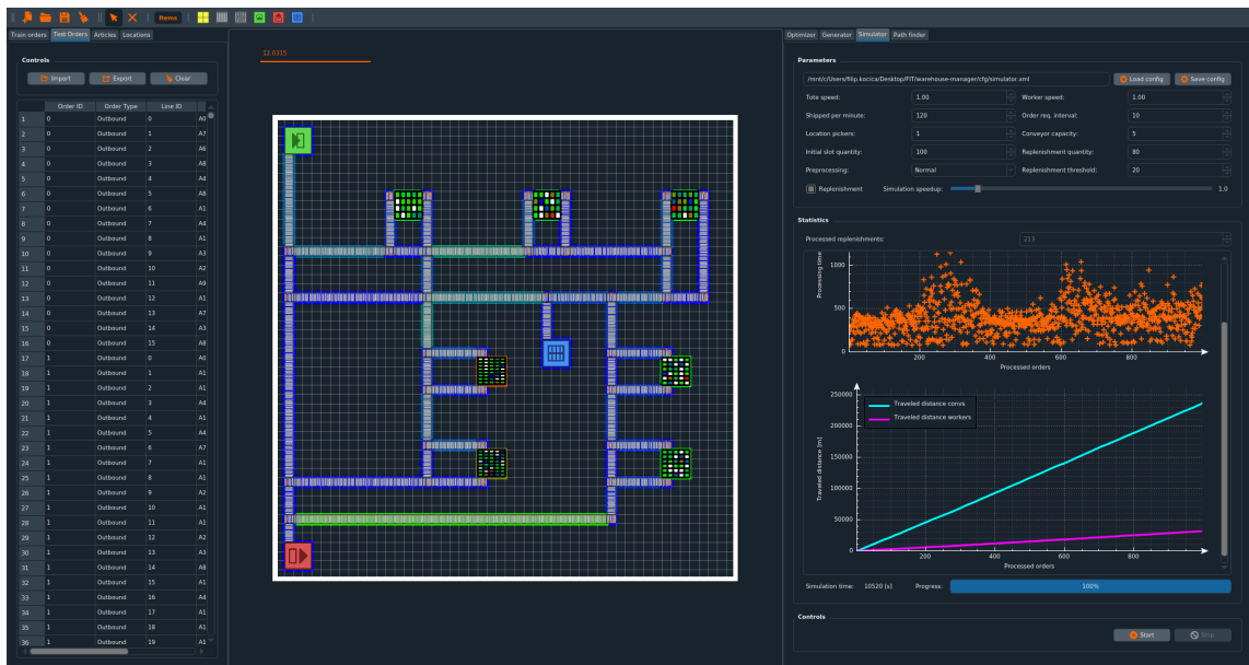
Obrázek 5.2: Grafická implementace simulátoru skladu zakomponovaná do aplikace Warehouse Manager. Uprostřed je stále plocha pro tvorbu modelu skladu. Vpravo je kontrolní panel, kde je možné nastavit parametry simulace, sledovat grafy simulace (časy dokončení jednotlivých zákaznických objednávek, nárůst ujeté vzdálenosti na dopravnících a ušlé vzdálenosti pracovníků), vidět počet dokončených doplňovacích objednávek a kontrolovat simulaci (spustit, zastavit). Vlevo jsou data, které simulátor používá, jako je testovací sada objednávek a alokace produktů do slotů lokací. V modelu skladu lze vidět, které sloty lokací jsou zaplněny a je zobrazena také teplotní mapa produktů v lokacích i jednotlivých grafických prvků, kterou lze vidět na snímku 5.8 a která reprezentuje zatížení prvků.
