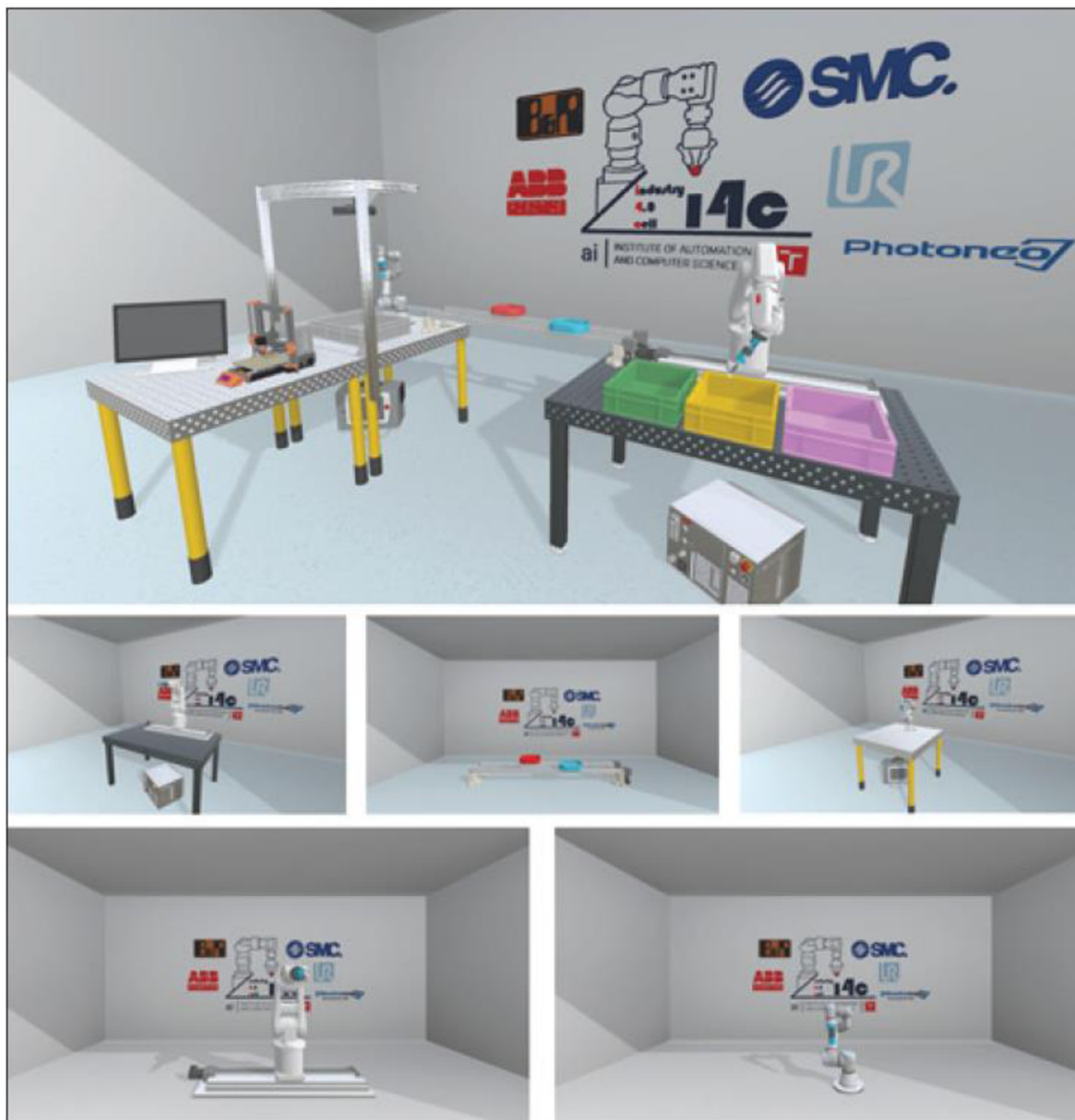
Obrázek 10: Digitální dvojče robotické buňky (převzato z [28])
