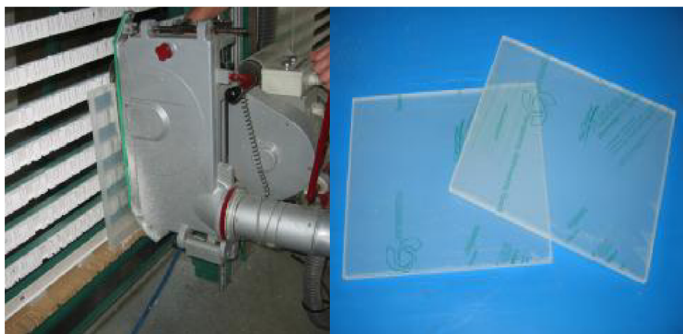
Obr. 4.1.2. Řezání na formátovací pile a výsledné přířezy v ochranné fólii
