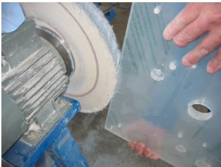
Obr. 4.5.2 Leštění obvodů a fazet na stojanové leštičce
