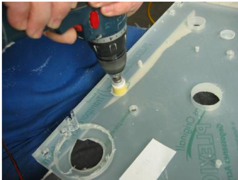
Obr. 4.4.1 Broušení otvorů pomocí brousících přípravků
