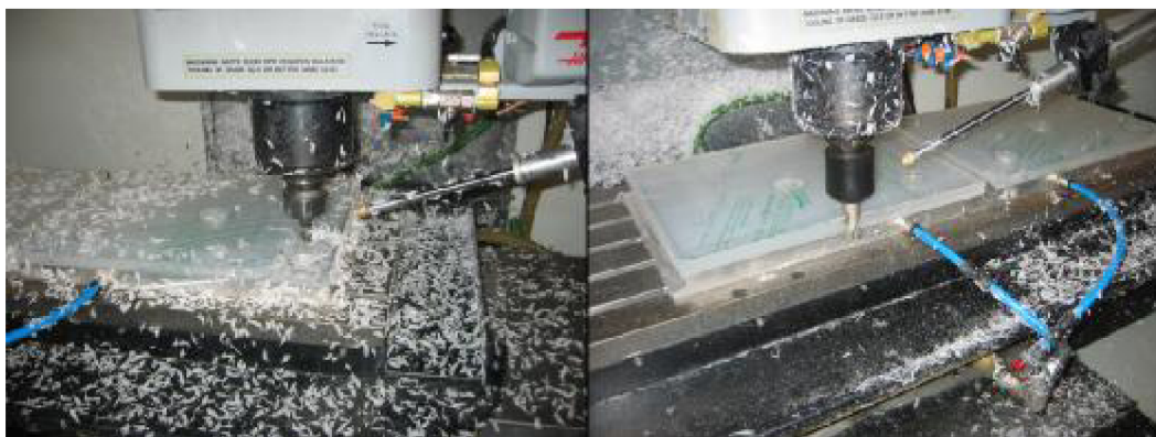
Obr. 4.3.10 Frézování plexiskla na stroji HAAS VF4
