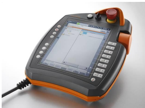
Obr.23 Teach pendant od spoločnosti KUKA[39]
