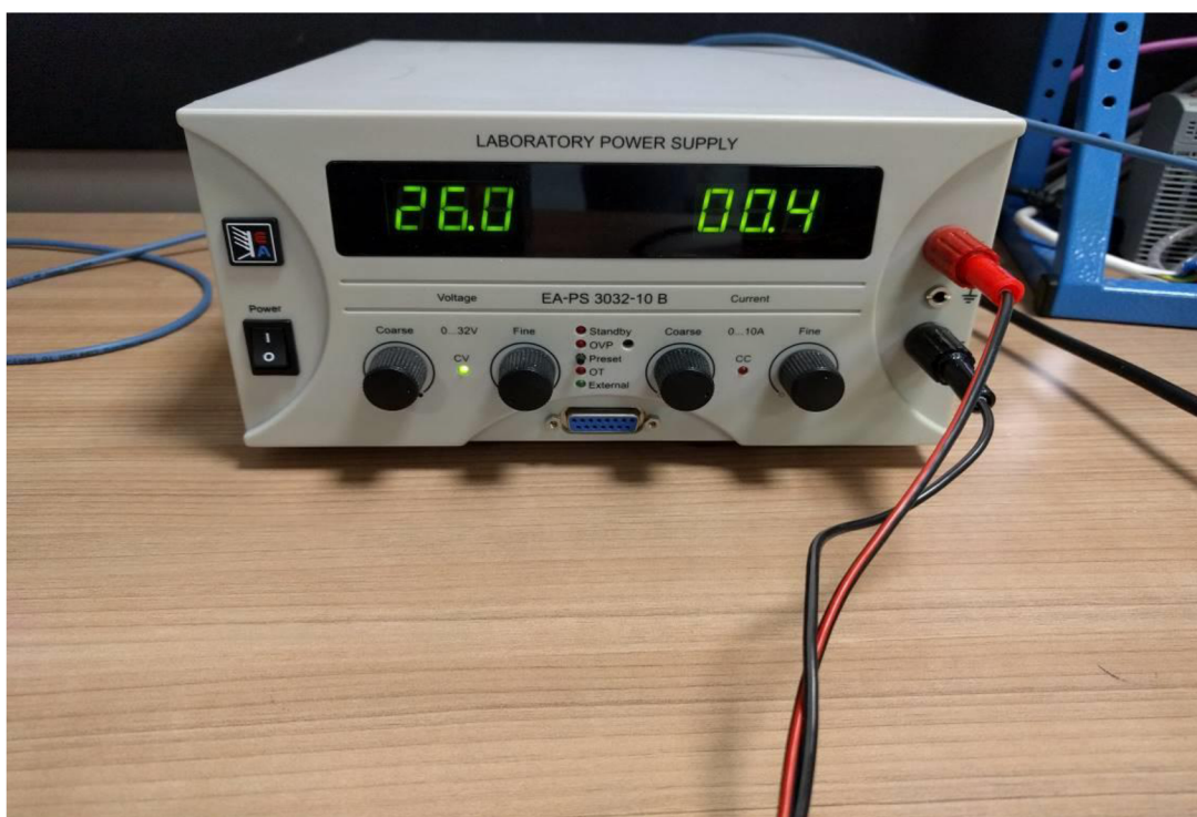
Obr.72 Laboratórny zdroj EA-PS 3032-10 B napájajúci PLC komunikačné moduly
