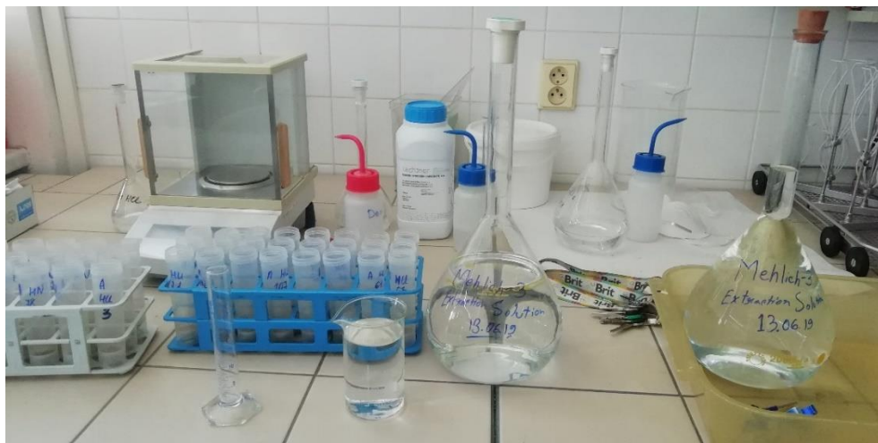
Obrázek 9. Extrahování vzorku metodou Mehlich III (Zdroj: vlastní foto).
