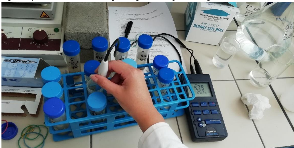
Obrázek 8. Stanovení pH pomocí pH metru (Zdroj: vlastní foto).
