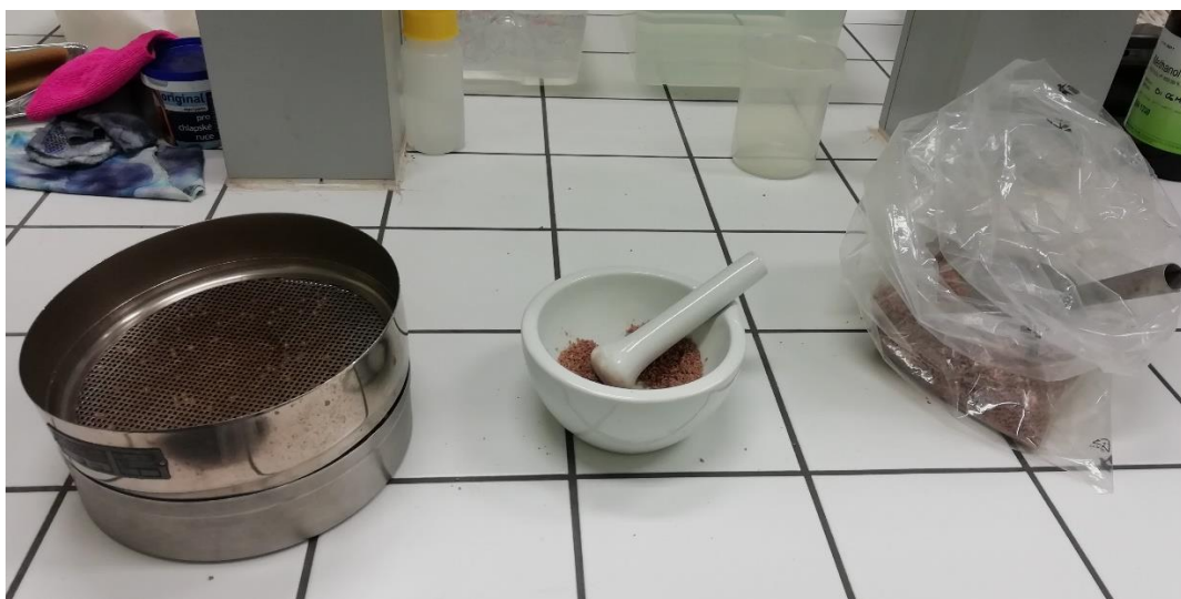
Obrázek 3. Materiál homogenizovaný v porcelánové třecí misce (Zdroj: vlastní foto).
