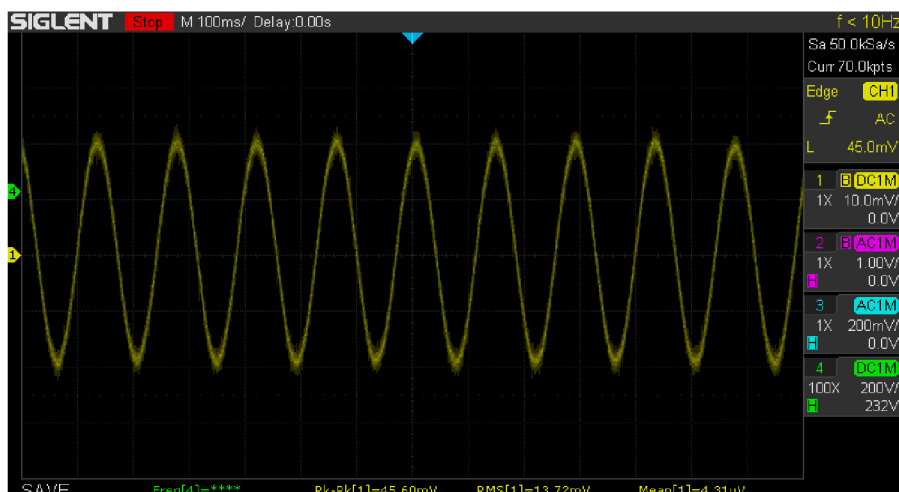
Obr. 5.1: Predzosilňovač, oscilogram, U_m = 20 \text{ uVpp} , 7 Hz
