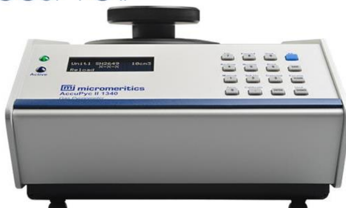
Obr. č. 23: Použitý heliový pyknometr - AccuPyc II 1340 [57]
