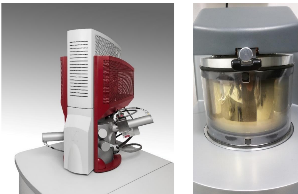
Obr. č. 49 a 50: Rastrovací elektronový mikroskop MIRA3 [55] a vakuovací (pozlacovací) komora Q150R
