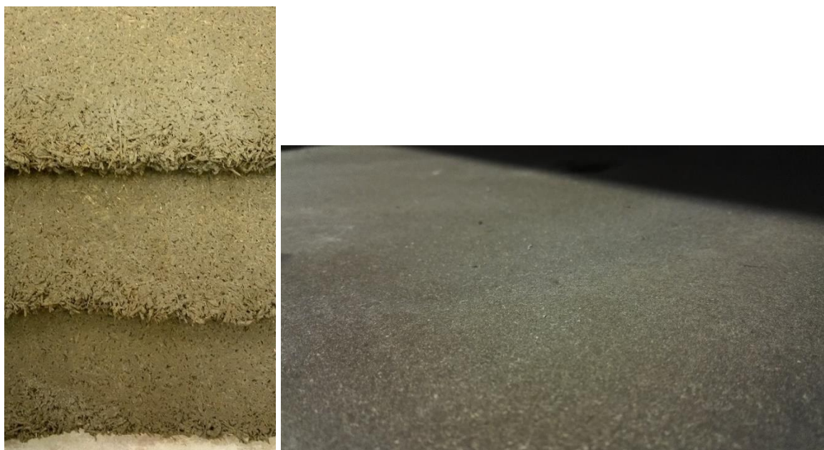
Obr. č. 45 a 46: Nenaformátované desky s různým obsahem škváry – lze pozorovat tmavnutí desky s rostoucím obsahem příměsi (vlevo), povrch spodní strany desky (vpravo)
