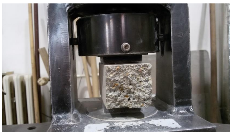
Obr. č. 39: Těleso umístěné v lisu pro zkoušení pevnosti v tlaku
