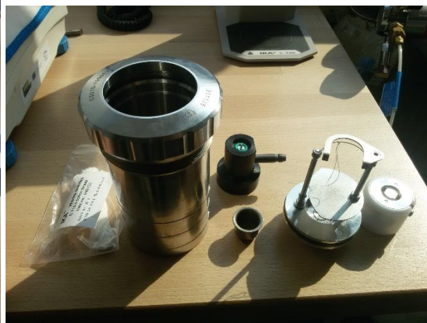
Obr. č. 27 a 28: Poloautomatický kalorimetr IKA C 200 (vlevo) a jeho vybavení (vpravo) (zleva - zápalné nitě, reakční nádoba, kelímek pro umístění tablety, víko nádoby)
