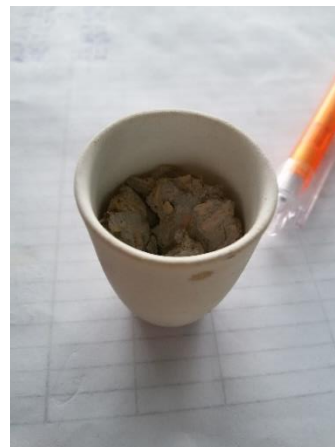
Obr. č. 30 a 31: Pec od firmy CLASIC a připravený vzorek frakce 8 - 16 mm pro termický rozklad
