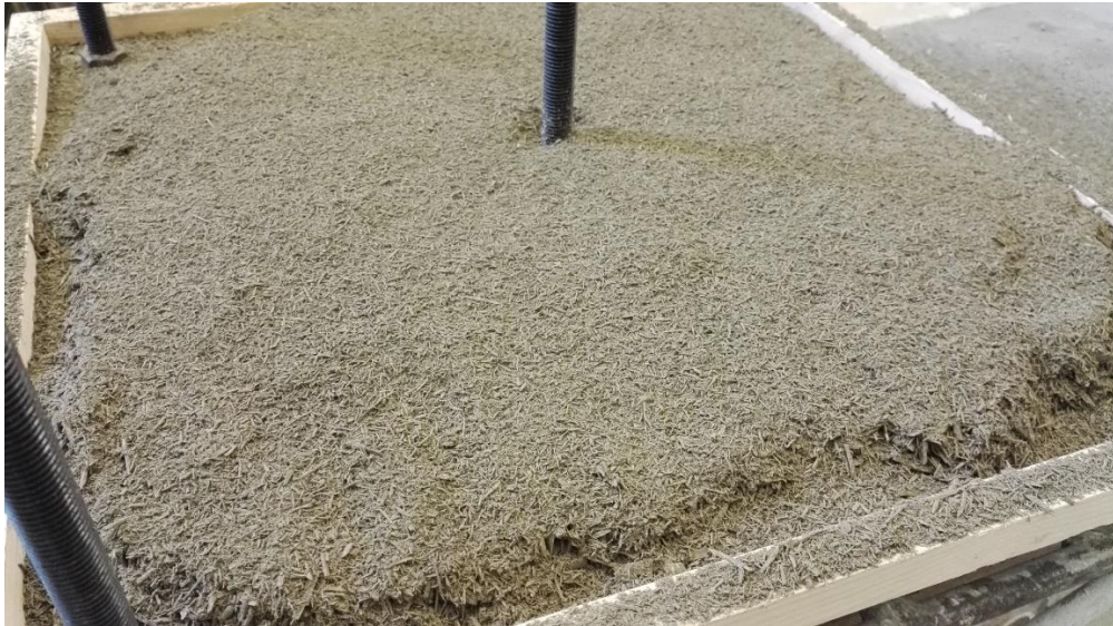
Obr. č. 40: Navrstvená směs pro výrobu cementotřískové desky – povrchové partie obsahující jemnější částice
