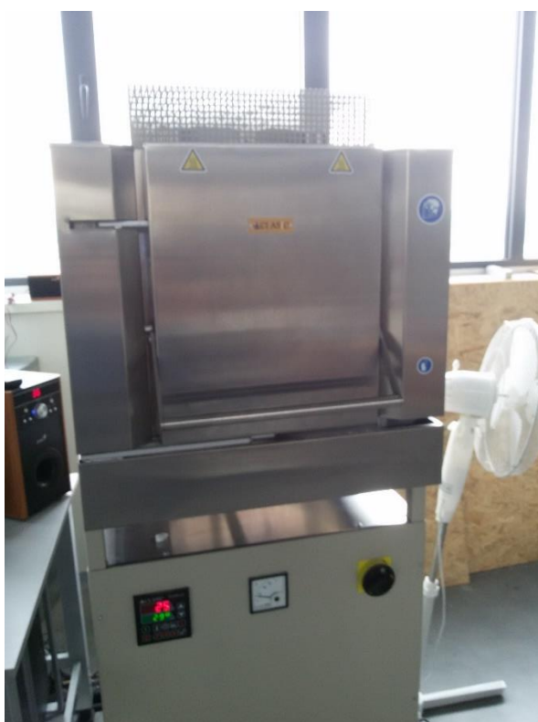
Obr. č. 30 a 31: Pec od firmy CLASIC a připravený vzorek frakce 8 - 16 mm pro termický rozklad
