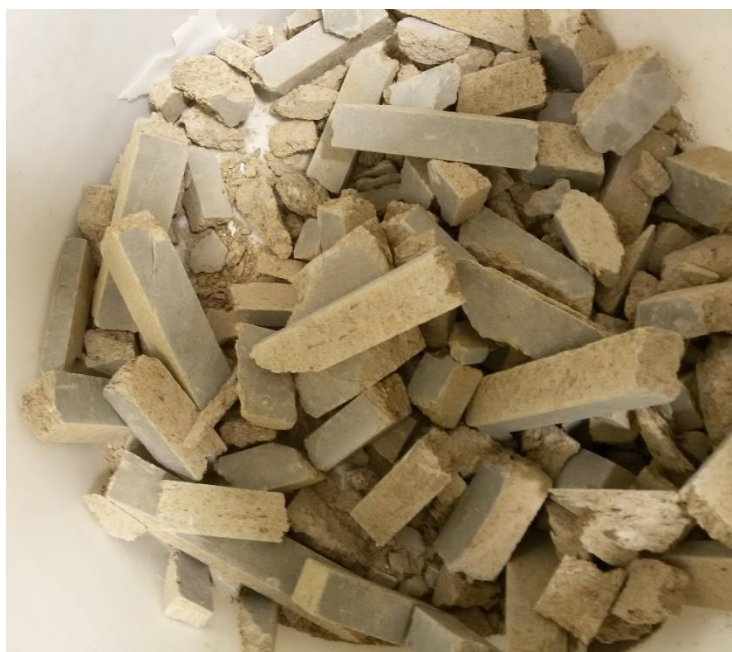
Obr. č. 24: Odřezky z formátování cementotřískových desek dodané přímo z výrobní linky spol. CIDEM Hranice, a.s.
