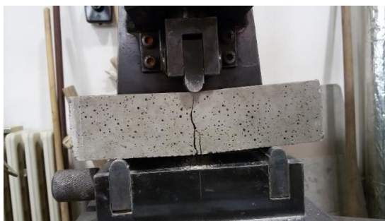
Obr. č. 38: Porušené těleso umístěné v lisu, po zkoušení pevnosti v tahu za ohybu
