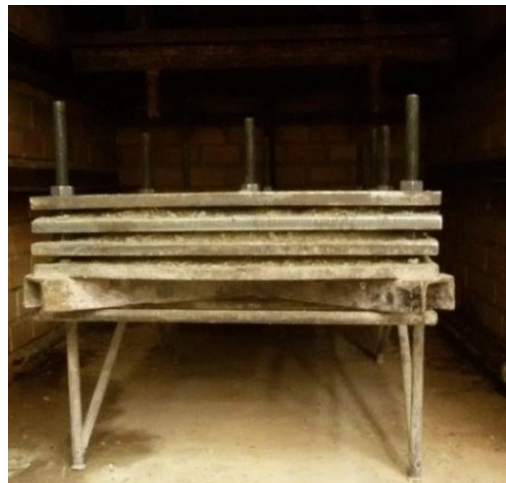
Obr. č. 44: Plné formy umístěné v proteplovací komoře.
