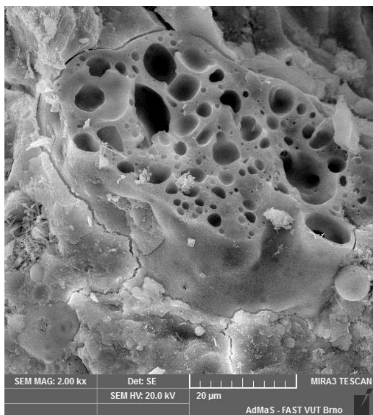
Obr. č. 56: SKV15,90 – Otevřená pórovitá struktura zrna škváry (zvětšeno 2000x)
