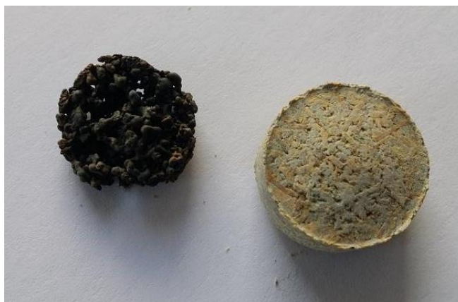
Obr. č. 29: Tableta po a před odzkoušením spalného tepla
