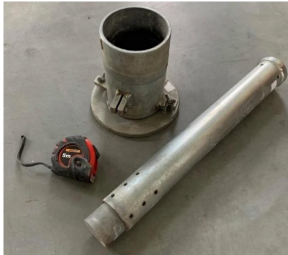
Obrázek 11: Ruční zkouška Proctor Standard (fotografie autora)
