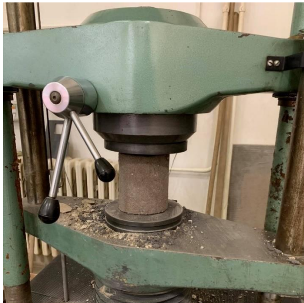
Obrázek 12: Zkouška pevnosti v tlaku (fotografie autora)
