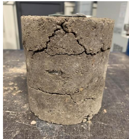
Obrázek 31: 90 % SAKO + 10 % Fluid. p. + 3 % CEM po 10. cyklech
