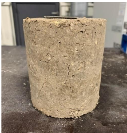
Obrázek 28: 90 % Bet. r. + 10 % Fluid. p. + 4 % CEM po 7. cyklech
