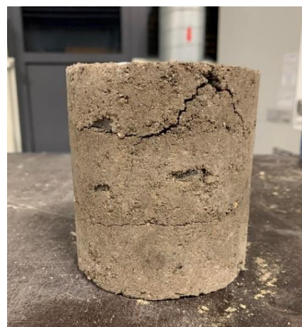
Obrázek 29: 90 % SAKO + 10 % Fluid. p. + 3 % CEM po 7. cyklech
