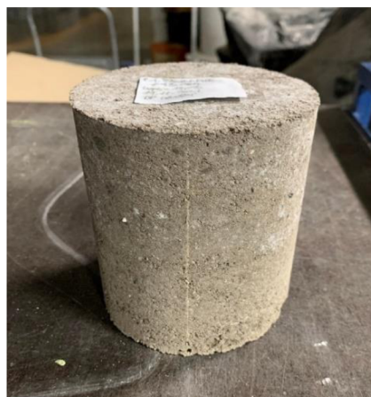
Obrázek 27: 90 % SAKO + 10 % Fluid. p. + 3 % CEM před zmrazovacími cykly
