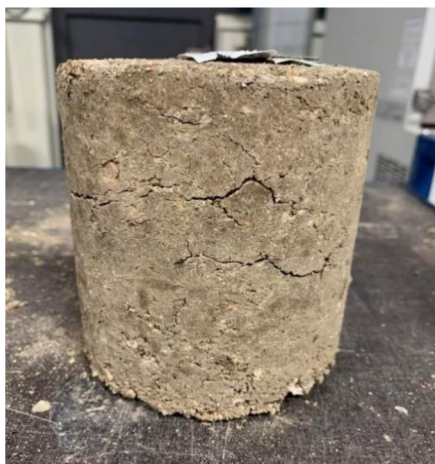
Obrázek 30: 90 % Bet. r. + 10 % Fluid. p. + 4 % CEM po 10. cyklech
