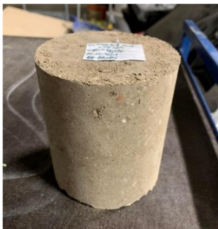
Obrázek 26: 90 % Bet. r. + 10 % Fluid. p. + 4 % CEM po 7. před zmrazovacími cykly
