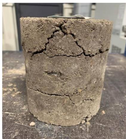
Obrázek 31: 90 % SAKO + 10 % Fluid. p. + 3 % CEM po 10. cyklech
