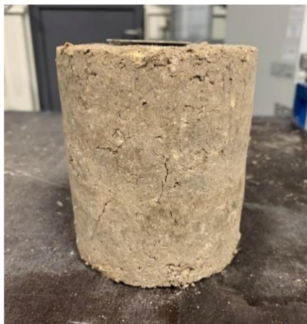
Obrázek 28: 90 % Bet. r. + 10 % Fluid. p. + 4 % CEM po 7. cyklech
