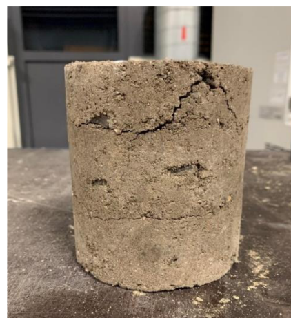
Obrázek 29: 90 % SAKO + 10 % Fluid. p. + 3 % CEM po 7. cyklech
