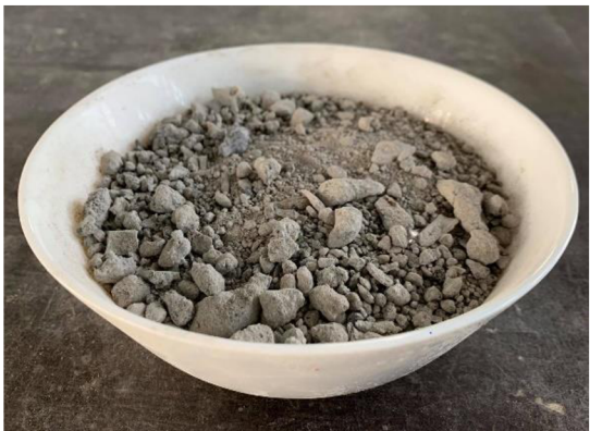
Obrázek 23: Škvára ze spalovny komunálních odpadů SAKO
