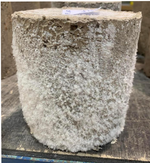
Obrázek 25: Výkvěty solí na směsném recyklátu s přidavkem odprašků z cementárny
