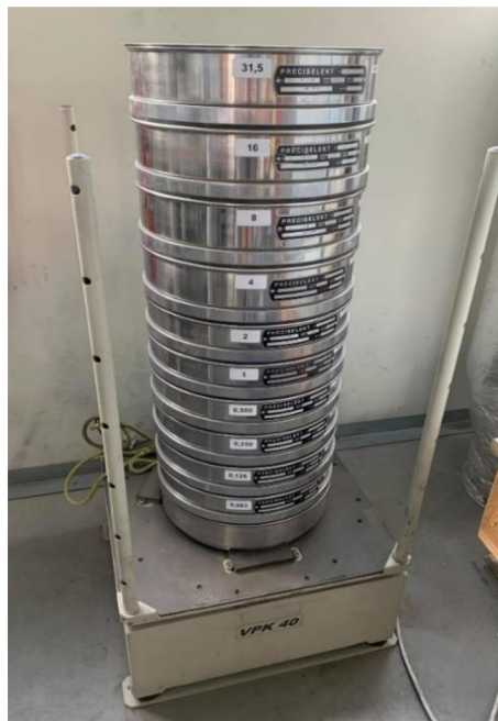
Obrázek 9: Normová sada sít a vibrační podložka VPK 40 (fotografie autora)
