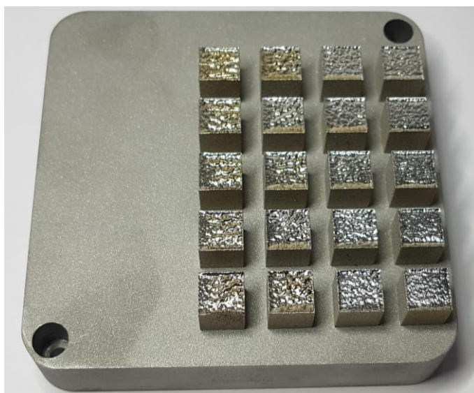
Obr. 5-7 První pokus o tisk vzorků pro vyhodnocení pod povrchové porozity
