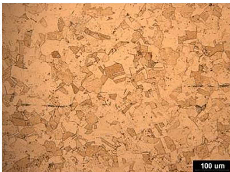
Obr. 2-26 Mikrostruktura oceli 316L po teplených úpravách [46]
