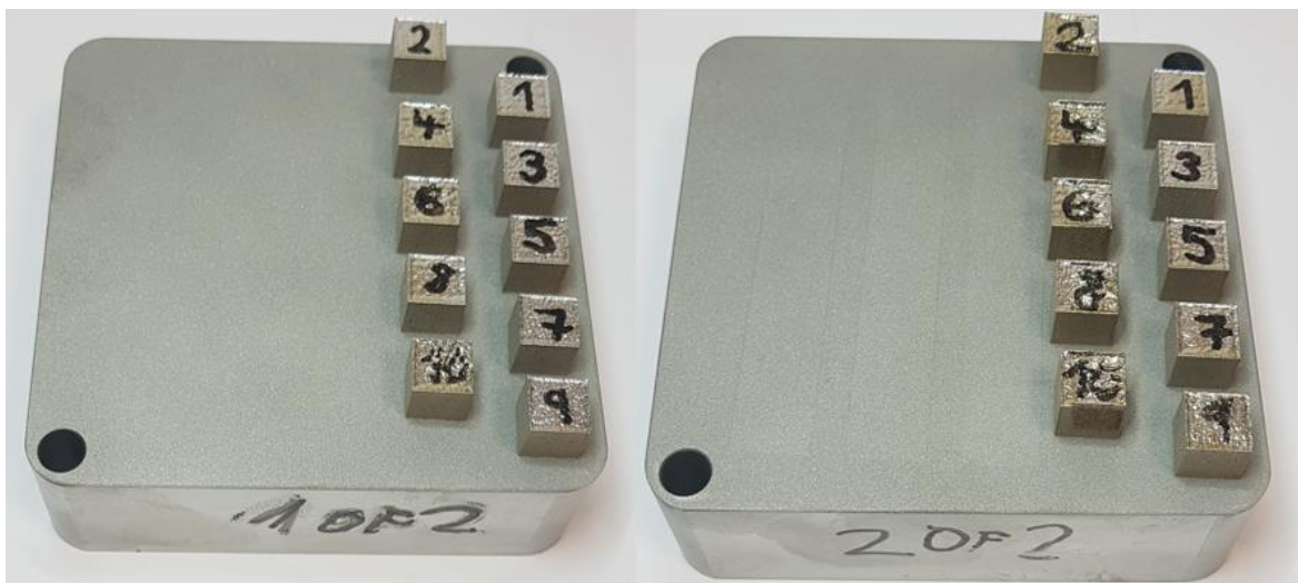
Obr. 5-8 Rozložení vzorků na platformě při testu pod povrchové porozity
