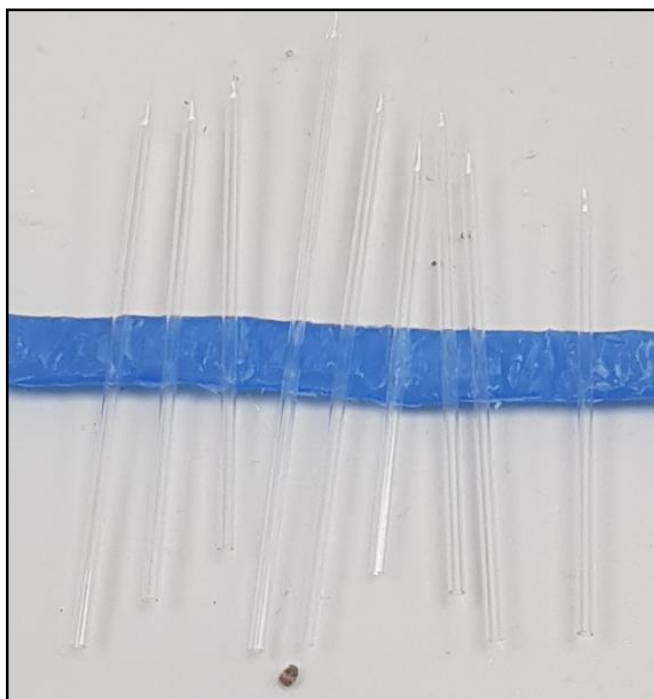
Příloha 2: Skleněné elektrody, používané pro zapojení tykadla, vyrobené pomocí vertikálního tahače PC-100. Autor: Jan Prchal
