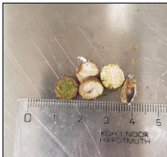
Obrázek 6: Vyražené smrkové disky o průměru 8 - 10 mm, které byly následně okrájeny, hluboce zmrazeny, rozdrčeny a pomocí roztoku hexanu s interním standardem extrahovány. Autor: Jan Prchal
