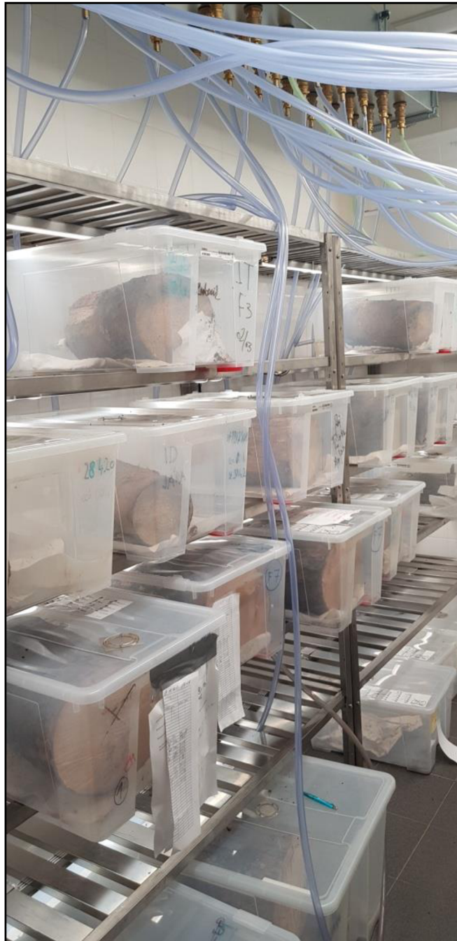
Obrázek 5: Chov kůrovců v laboratoři v plastových boxech (25 C teplota, vlhkost 66 %). Polena jsou podložena papírovou utěrkou. Do boxů je přivedena hadice pro odtah vzduchu. Na víku boxu je vidět kulatý otvor zakrytý sítkou pro přívod vzduchu. Autor: Jan Prchal
