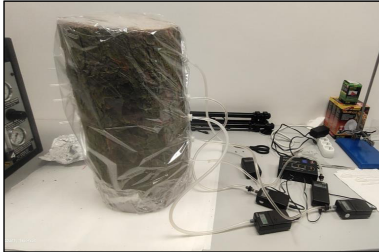
Obrázek 7: Jímání smrkové vůně na adsorbent. V pravé části jsou vzduchové pumpičky, které vysávaly vzduch 24 hodin rychlostí 100 ml vzduchu za hodinu. V levé části je vidět samotné poleno ze kterého byla vůně jímána. Autor: Jan Prchal
