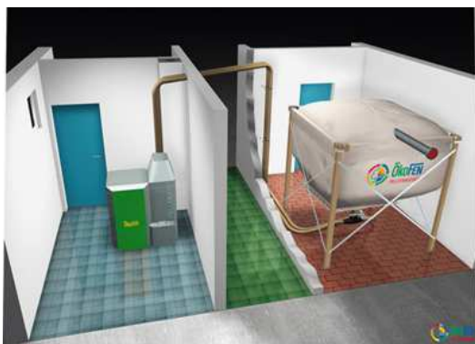
Obrázek 10 Pneumatická doprava pelet do kotle [9]
