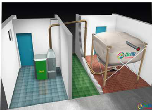
Obrázek 10 Pneumatická doprava pelet do kotle [9]
