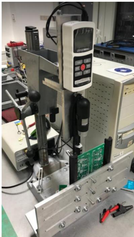
Obrázek 4.1 Pracoviště pro měření pevnosti pájených spojů [7]
