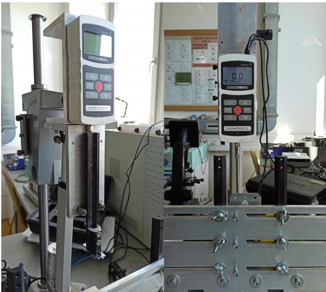
Obrázek 4.6 Pracoviště pro měření pevnosti pájených spojů, před úpravami bez kamery (vlevo) a po úpravách (vpravo).
