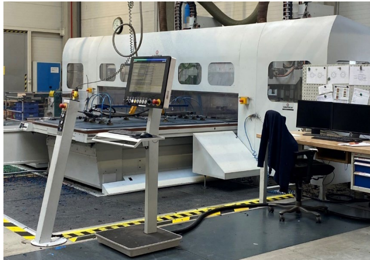
Obr. 20 Obráběcí centrum C. M. S. Spa – Karat 9530.
