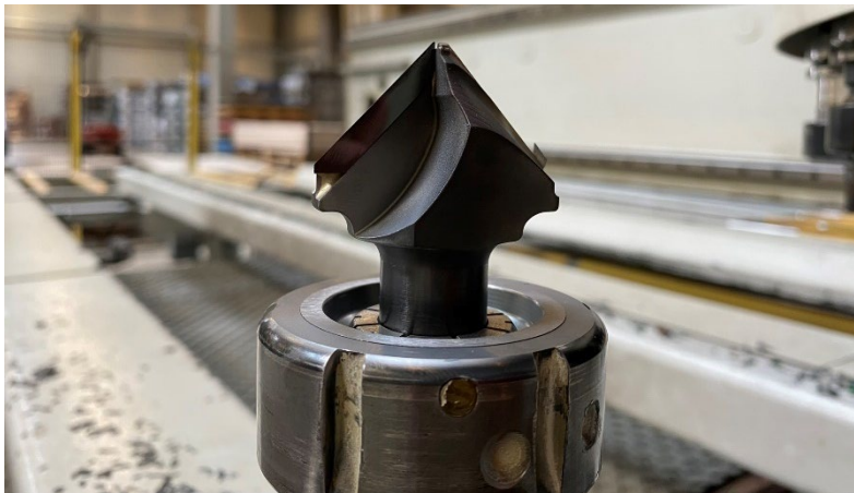
Obr. 13 Válcová fréza s charakteristickou funkční plochou pro zkosení po úhlem 45°.
