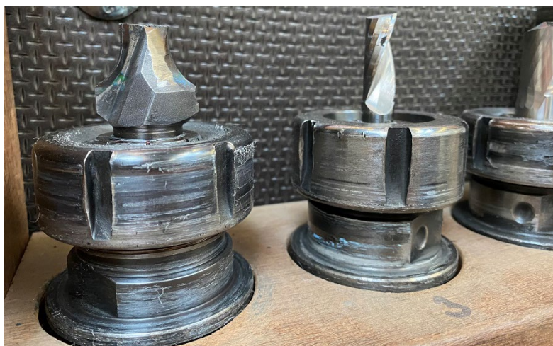
Obr. 12 Upnutí frézy pomocí kleštinového upínače s ISO kuželem.
