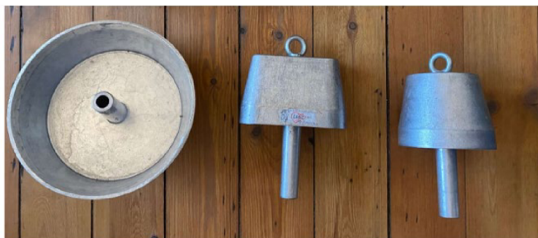
Obr. 14 Přípravky pro kontrolu bezpečnosti – velká hlava, torzo těla a malá hlava.
