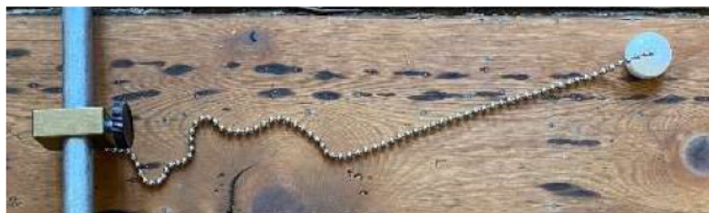
Obr. 17 Přípravek pro kontrolu bezpečnosti – šňůrka na mikině – podle vnitřních norem.
