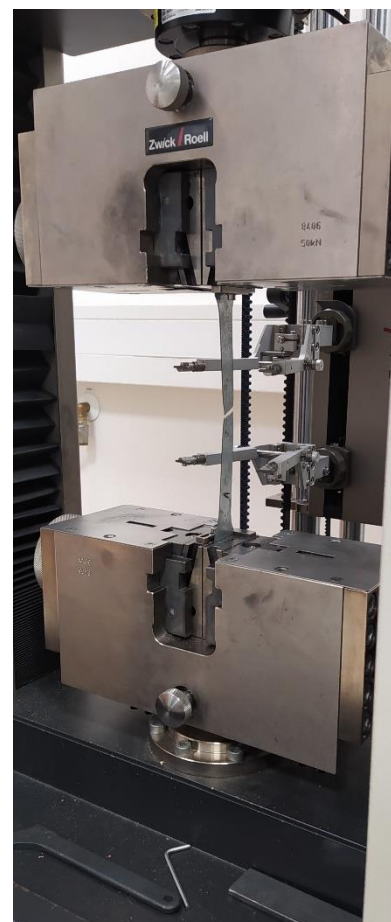
Obr. 40 Trhací stroj Zwick Roell
