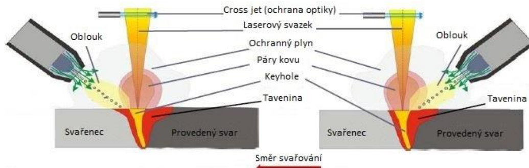
Obr. 18 Konfigurace hybridního svařování [15]
