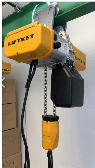
Obrázek 33: Navržený kladkostroj s pojezdem [49]
