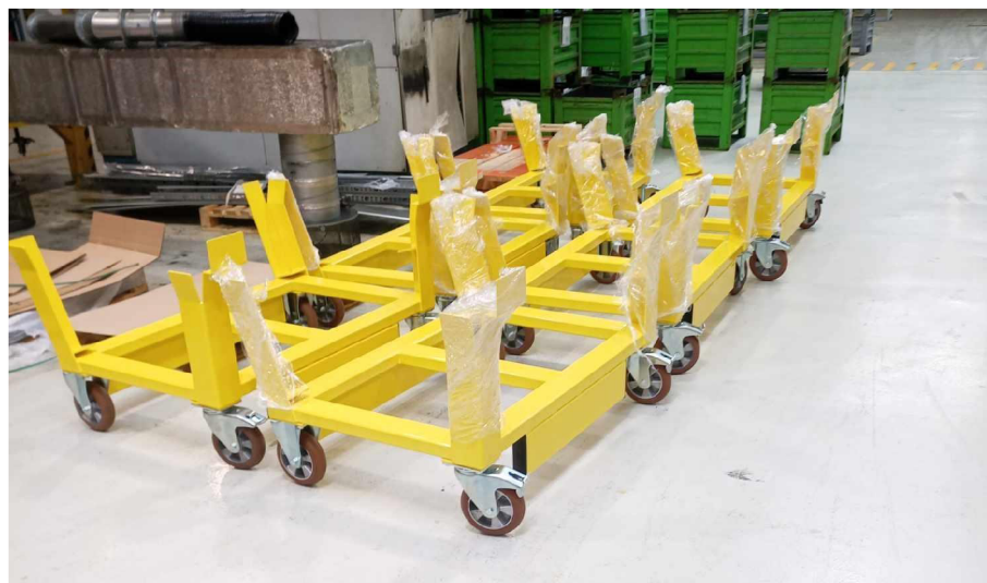
Obrázek 10: Vozík pro skladovací box s úpravou AGV [vlastní]
