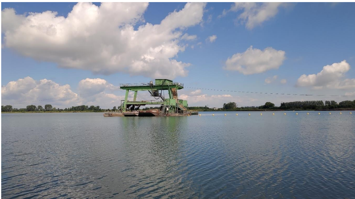
Obrázek 9: Plovoucí těžební zařízení určené k dobývání štěrku [L. Tomšej, 2020]
