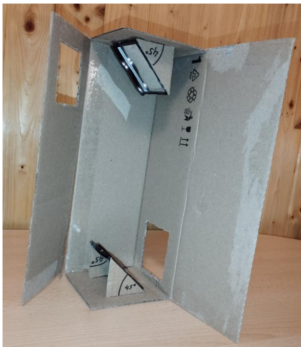
Obrázek 5: Umístění zrcátek v periskopu.
