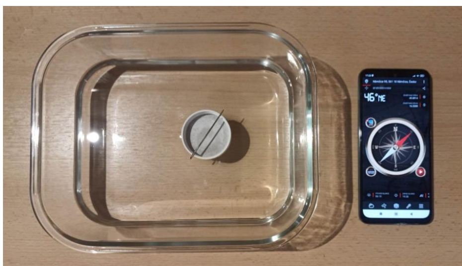
Obrázek 31: Vodní kompas ukazující směr severu a jihu.
