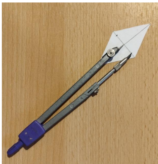
Obrázek 27: Umístění dírek ve střelce vzdušného kompasu.
