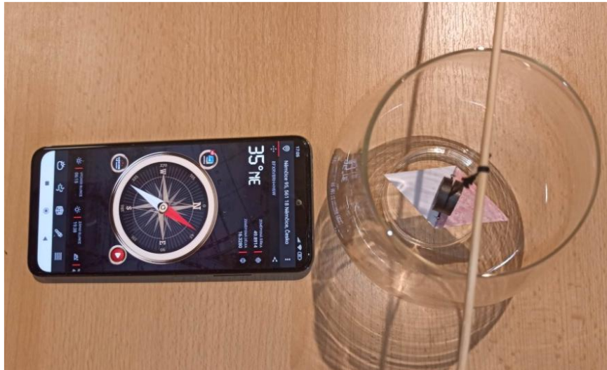
Obrázek 29: Vzdušný kompas ukazující přibližný směr severu a jihu.
