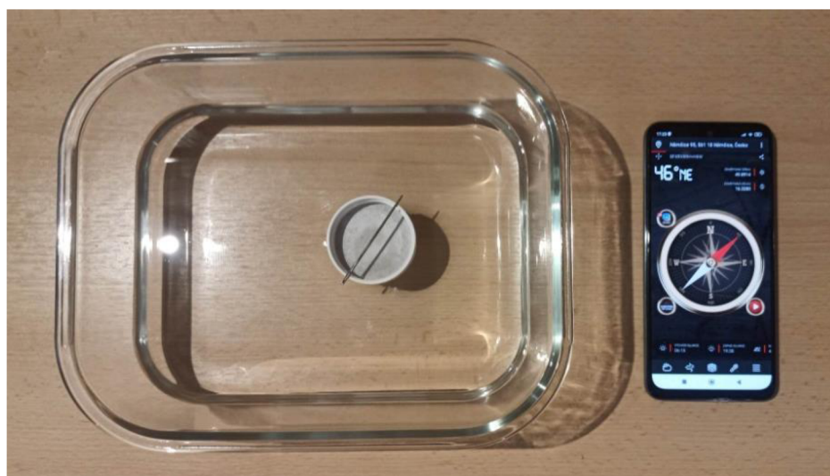
Obrázek 31: Vodní kompas ukazující směr severu a jihu.
