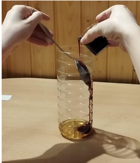
Obrázek 14: Postupné vrstvení kapalin s odlišnou hustotou.
