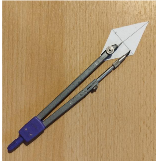
Obrázek 27: Umístění dírek ve střelce vzdušného kompasu.
