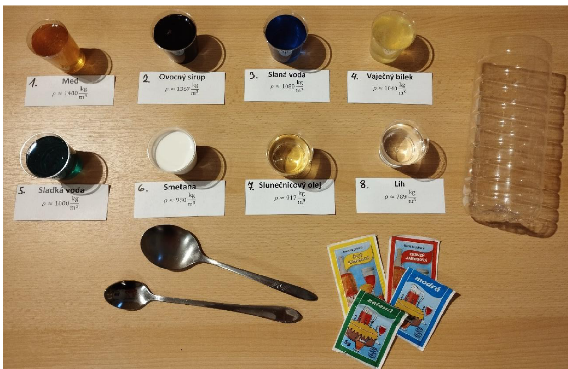
Obrázek 13: Použité pomůcky a kapaliny v první variantě experimentu Archimédův koktejl.
