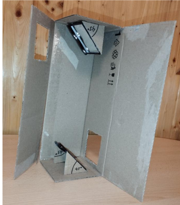
Obrázek 5: Umístění zrcátek v periskopu.
