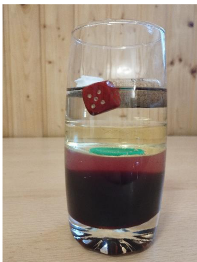
Obrázek 19: Pevná tělesa umístěná v Archimédově koktejlu.
