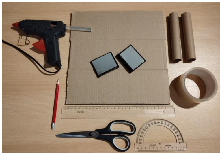
Obrázek 1: Pomůcky a materiál využitý při výrobě periskopu.
