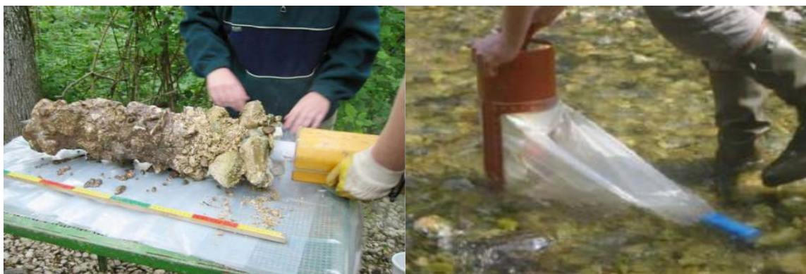
Obrázek 14: Metoda freezing core – vlevo a vzorkovač Lunz – vpravo (zdroj: Wagner & Leichtfried 2003; upraveno: Šmídová 2023).
