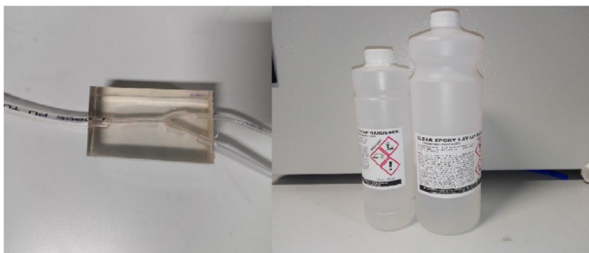
Obr. 16 a) hotový epoxidový model b) materiál pro výrobu modelu [foto autor]
