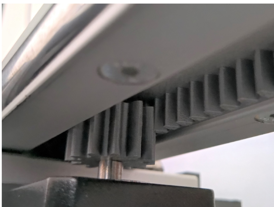
Obrázek 4.6: Detail tištěného ozubeného spojení krokového motoru s lineárním posuvem, přes ozubení umístěné do drážky posuvu.
