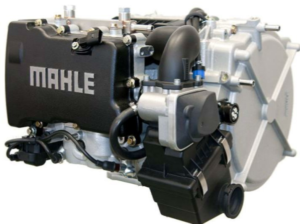
Obr. 29 MAHLE Prodlužovač dojezdu (vlevo) [48] Obr. 30 Uspořádání klikové hřídele (vpravo) [48]
