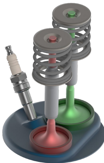
Obr. 99 Rozmístění ventilů ve spalovacím prostoru
