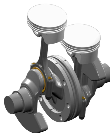
Obr. 29 MAHLE Prodlužovač dojezdu (vlevo) [48] Obr. 30 Uspořádání klikové hřídele (vpravo) [48]
