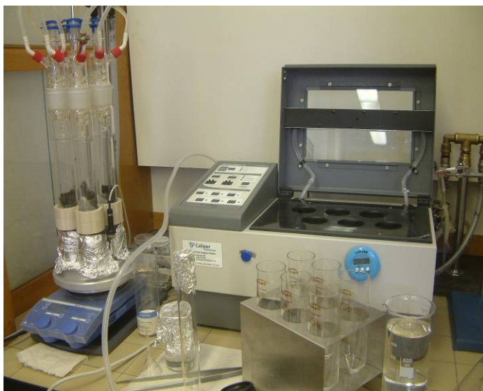
Obr. 8: Extraktor IKA, vpravo TurboVap
