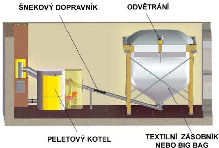
Obr. 14 Skladování pelet v textilním zásobníku [13]
