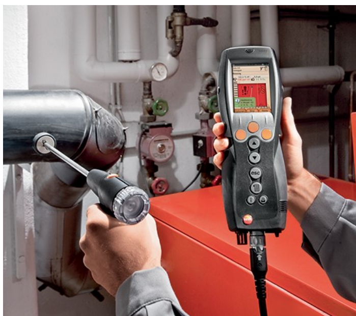
Obr. 24 Měření účinnosti pomocí analyzátoru spalin [21]
