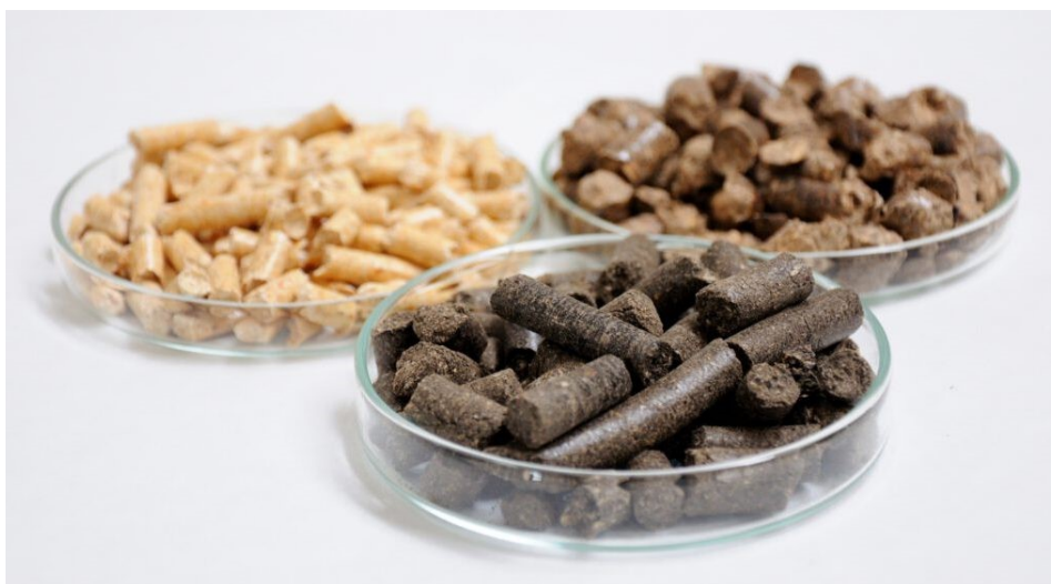
Obr. 13 Znázornění vzhledové odlišnosti jednotlivých tříd pelet [11]
