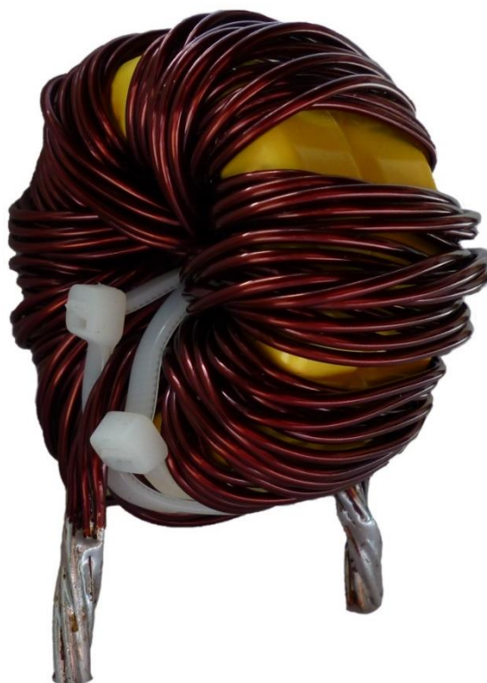
Obr. 2.5 Vyhotovená tlmivka pripravená na zaspájkovanie do DPS
