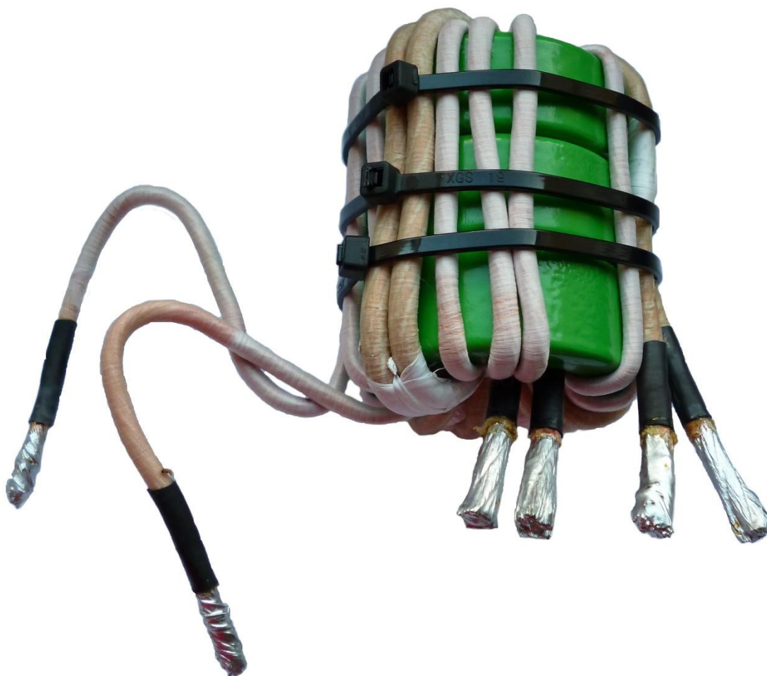
Obr. 2.3 Vyhotovený transformátora pripravený na zaspájkovanie do DPS
