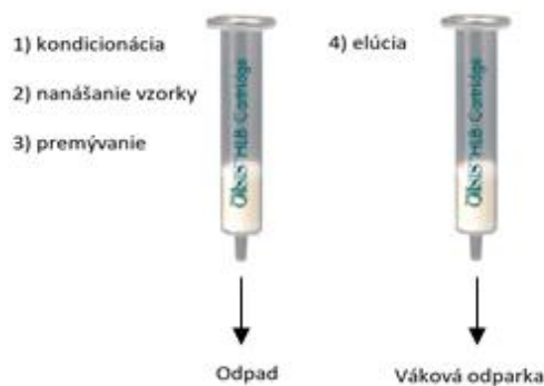
Obr. 11. Schéma SPE purifikácia pomocou Oasis® HLB (30 mg/ml).
