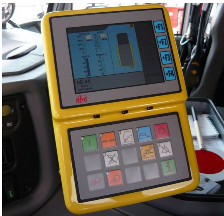
Obr. 5 – Ovládání systému THTronic z místa řidiče [8]
