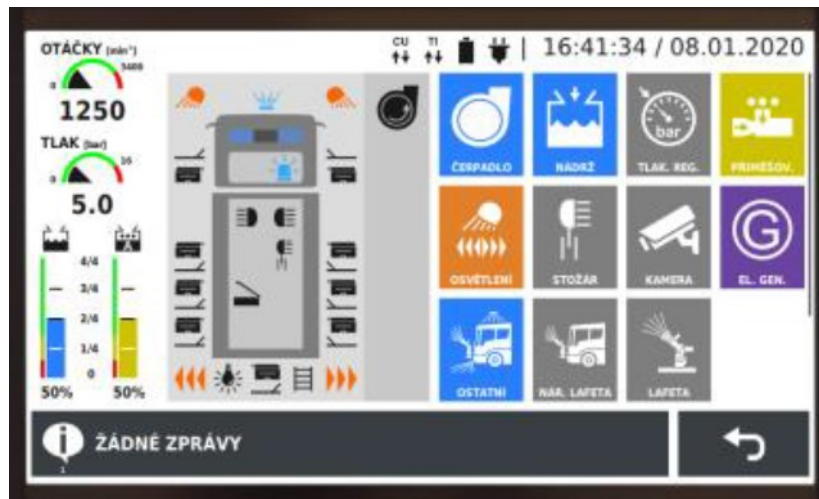
Obr. 7 – Úvodní obrazovka systému řízení účelové nástavby od společnosti RCE Brno [8]
