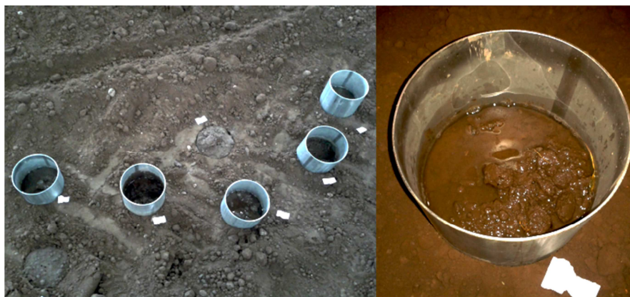
Obrázek 21 – Fotografie z měření nasycené hydraulické vodivosti
