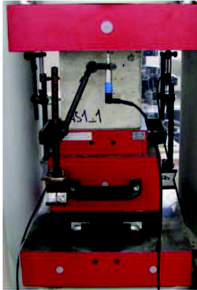
Obrázek 2-1: Uspořádání tlakové zkoušky
