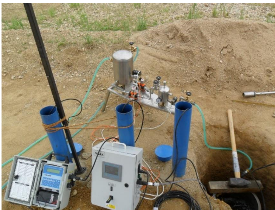
Obrázek č. 14: Vsakovací zkouška (Geostar, ©2021)
