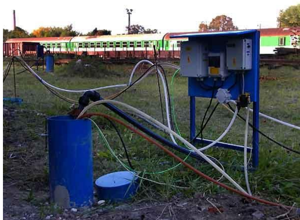
Obrázek č. 21: Elektronika udržující konstantní hladinu v sanačním vrtu (Lidařík, s©2021)
