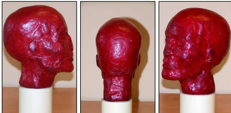
Obr. 2.5 Kalibrační fantom lidské lebky pro kalibraci měření ^{241}\text{Am} deponovaného v kostře.
