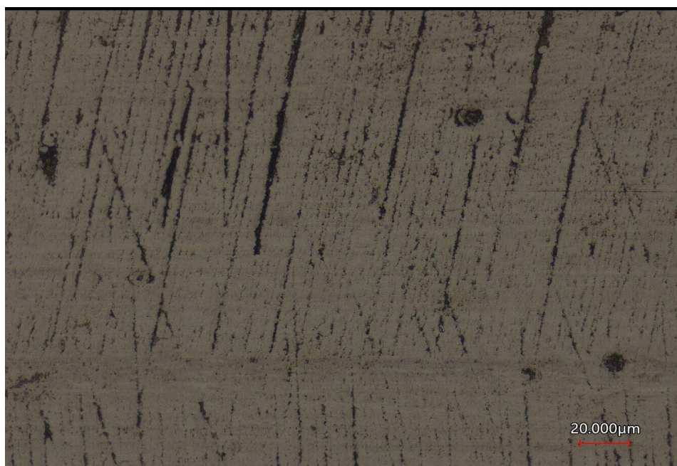
Obr.52 Finálny povrch tesniaceho piestneho krúžku s povlakom CrCN47
