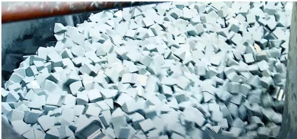
Obr.43 Pranie piestnych krúžkov s omývacími kameňmi
