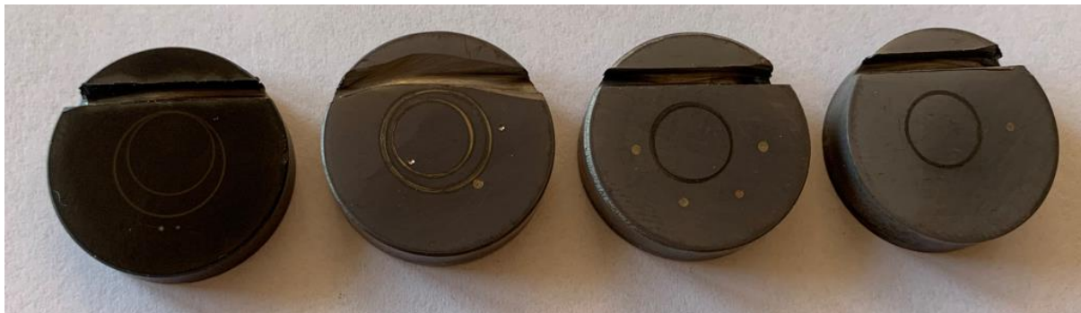
Obr.54 Použité vzorky, Zľava DLC, CrCN47, CrCN48, CrN
