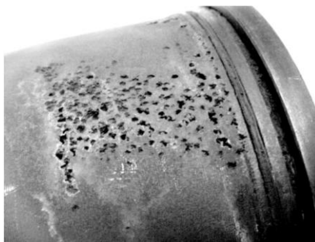
Obr.20 Kavitačné opotrebenie pláštu piestu [16]
