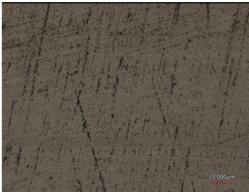
Obr.51 Finálny povrch tesniaceho piestneho krúžku s povlakom CrCN48
