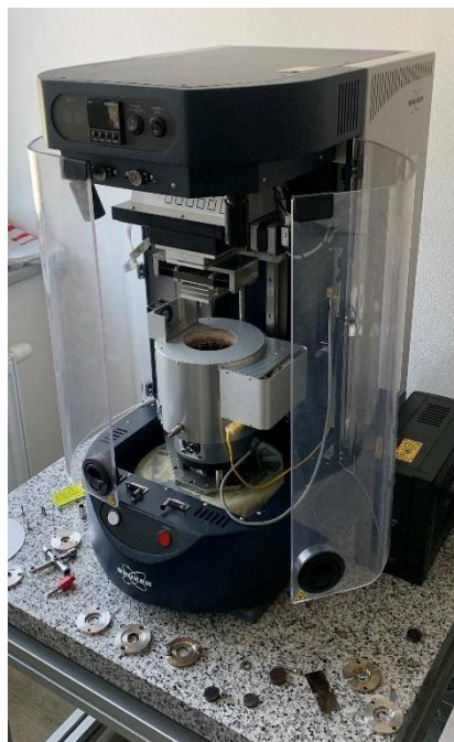
Obr. 57 Tribologické zariadenie Bruker UMT TriboLab
