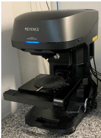
Obr.61 Konfokálny 3D skenovací laserový mikroskop
