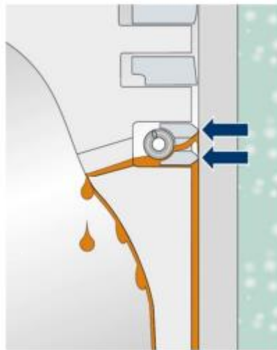
Obr.5 Odvádzanie tepla piestnymi krúžkami [4]
