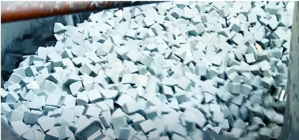
Obr.43 Pranie piestnych krúžkov s omývacími kameňmi
