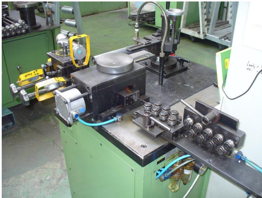
Obr.40 Natočenie drôtu piestneho krúžku
