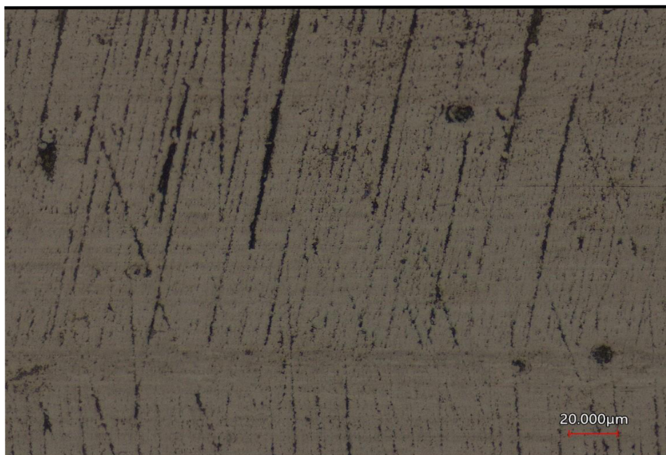
Obr.52 Finálny povrch tesniaceho piestneho krúžku s povlakom CrCN47
