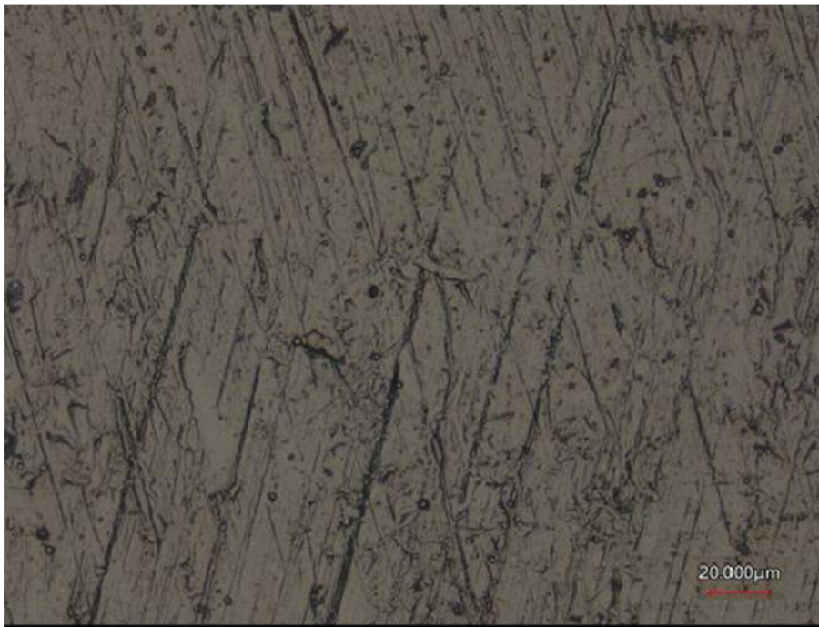
Obr.53 Finálny povrch tesniaceho piestneho krúžku s povlakom DLC
