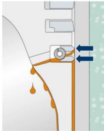
Obr.5 Odvádzanie tepla piestnymi krúžkami [4]
