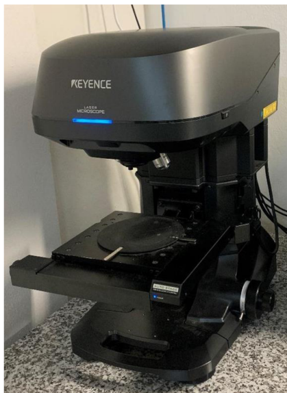
Obr.61 Konfokálny 3D skenovací laserový mikroskop
