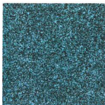
Obr.39 Štruktúra materiálu BS-13, leptané Nital, zväčšenie 500x
