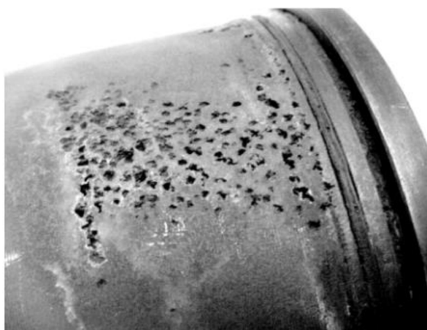
Obr.20 Kavitačné opotrebenie pláštu piestu [16]
