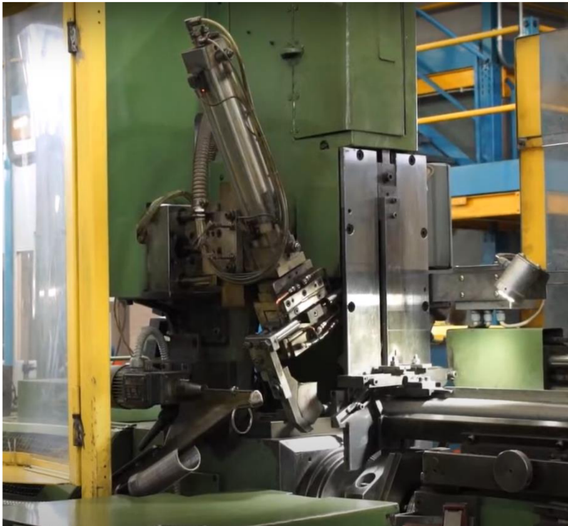
Obr.41 Obrábanie piestnych krúžkov na požadovaný rozmer
