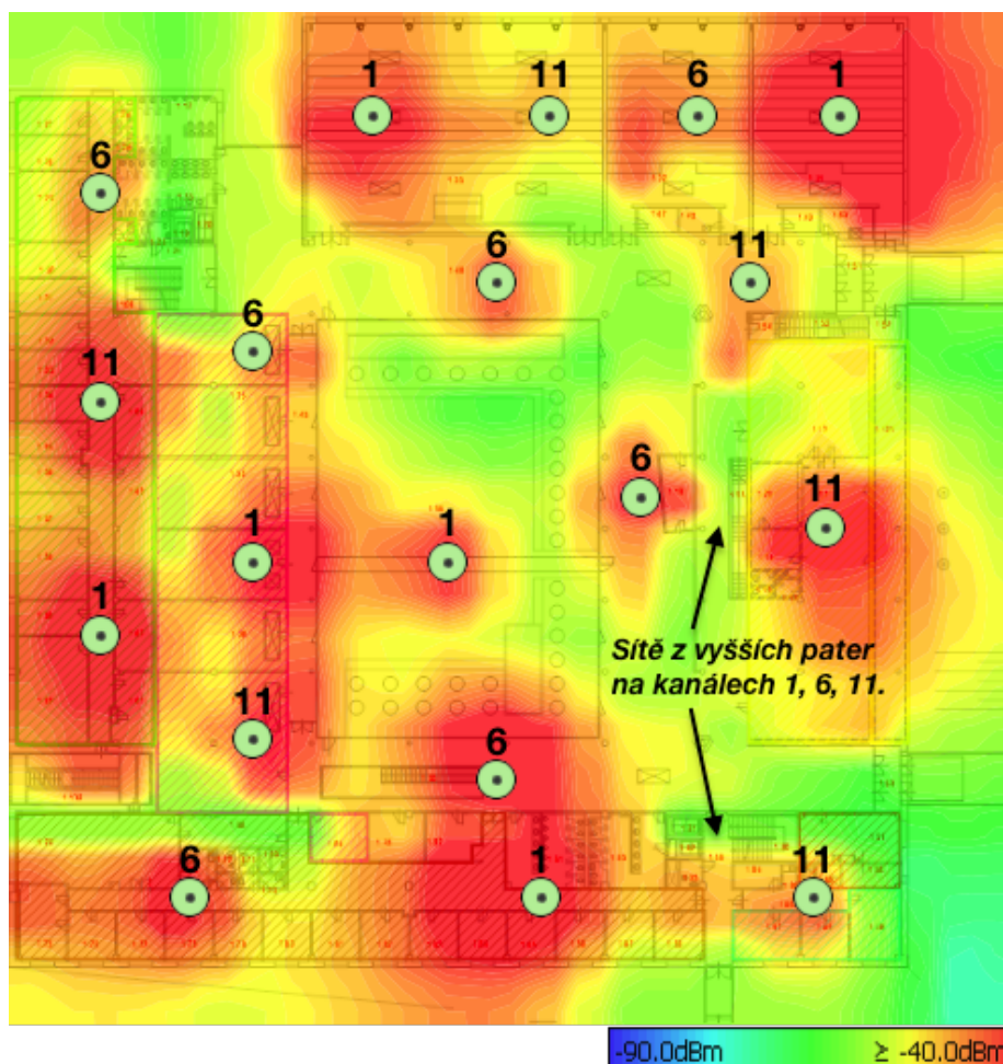
Obr. 18: Mapa pokrytí 1. NP budovy Q WiFi signálem, pozice AP a využití kanály.
