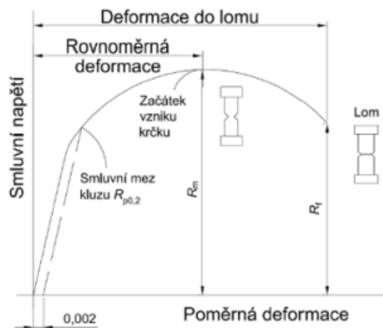
Obr. 2.10 – Smluvní diagram napětí – deformace [3]
