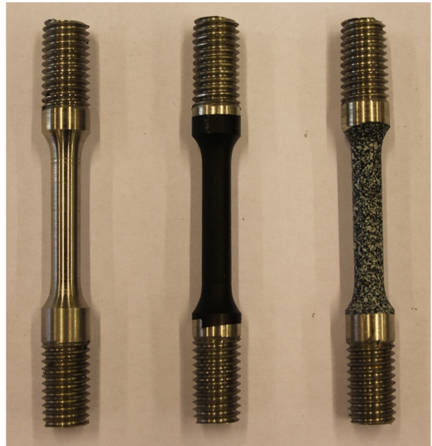
Obr. 3.5 – Zkušební vzorek z ocele 1.4301
