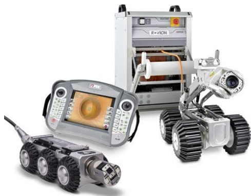
Obr. 33- Inspekční kamerový systém
