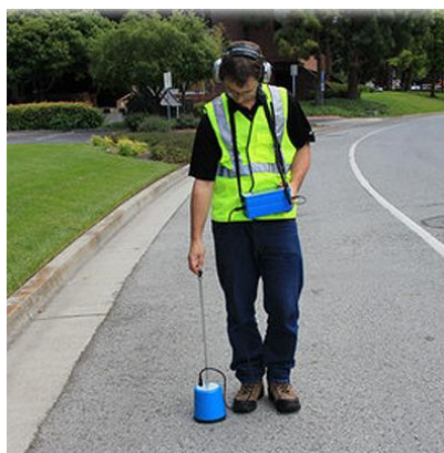
Obr. 27 - Použití půdního mikrofonu
