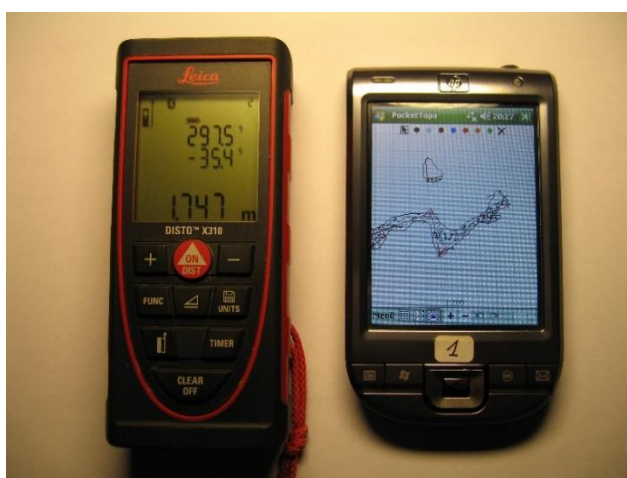
Obr. 4.6 Ukázka synchronizace DistoX2 s dalším zařízením [11]
