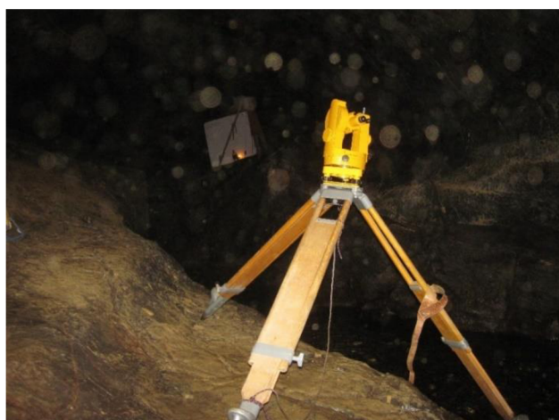
Obr. 4.3 Ukázka průběhu měření vrcholových úhlů polygonu (Foto T. Zubík)
