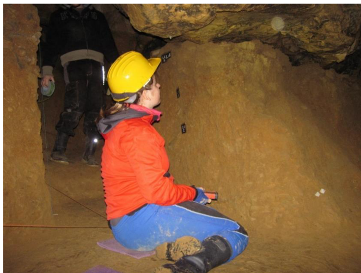
Obr. 4.4 Průběh měření šikmých délek polygonového pořadu (Foto T. Zubik)
