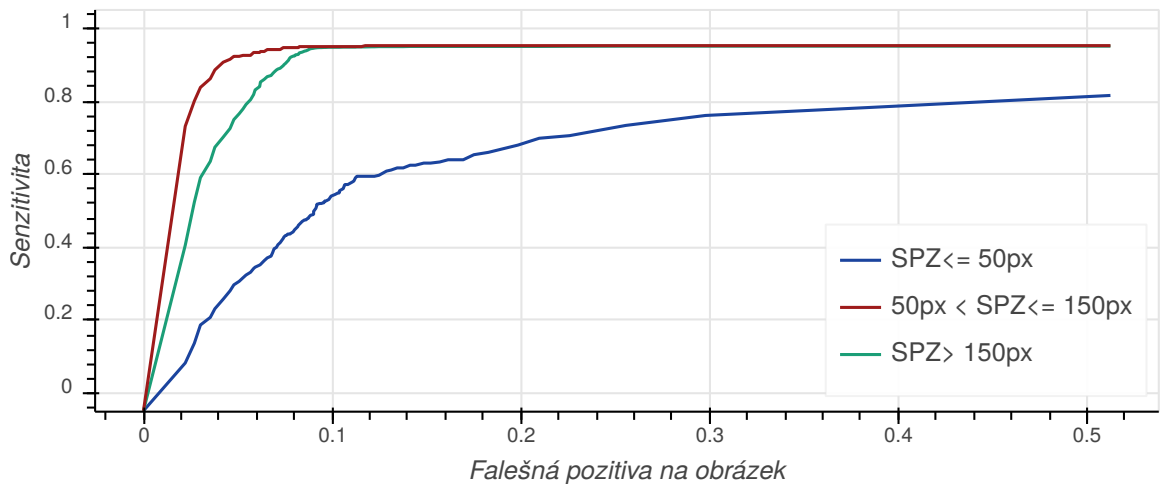
Obrázek 6.6: Úspěšnost detekcí registračních značek v různých velikostních kategoriích. Z grafu lze vyčíst, že model má velmi často problém správně detekovat malé registrační značky o velikosti \leq 50 px, naopak velmi dobře zvládá detekovat středně velké a velké značky.
