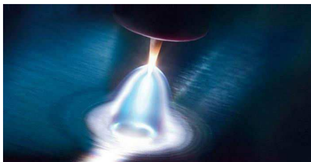
Obr. 2 Elektrický oblouk chráněn inertním plynem u metody TIG [13]
